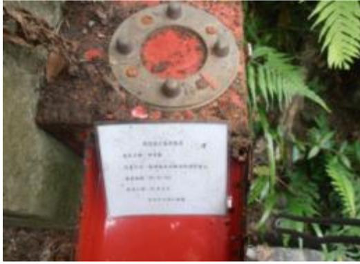
圖 4-6 140 高地公園地質監測系統傾度盤
